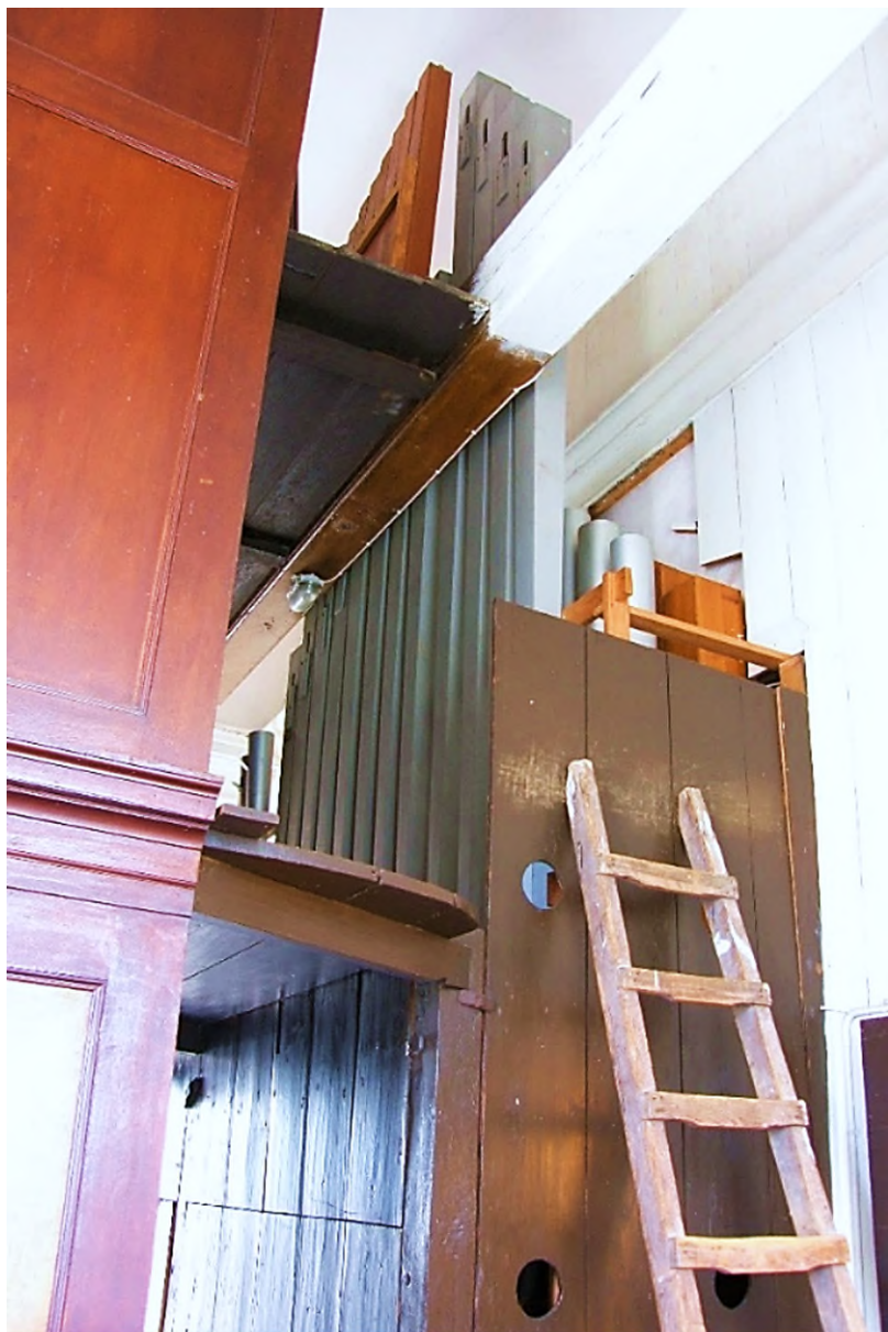
De aan de bovenkant ingekorte balgkast met daarin het Pedaalwerk van 1931 met aan de voorzijde de grenen bekers van de Bazuin 16 voet.
