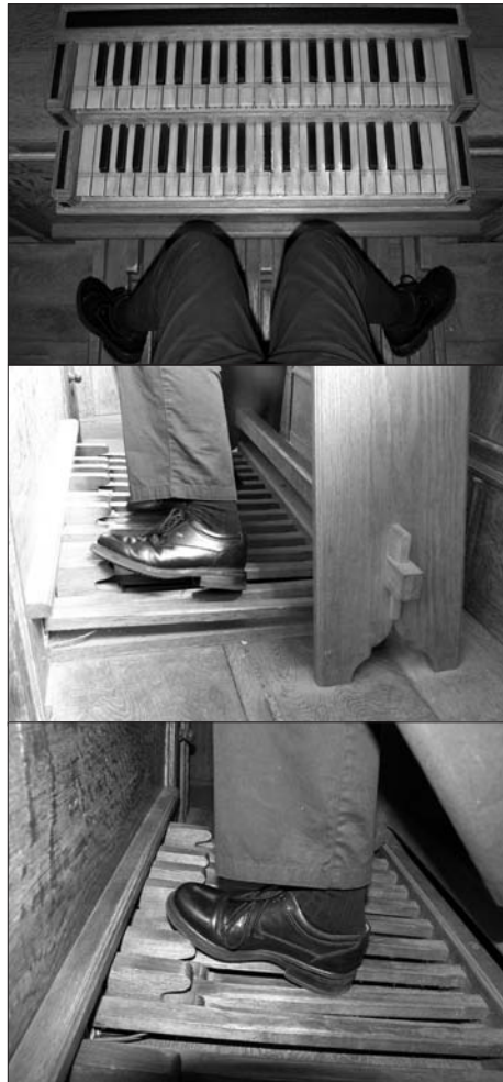
Enkele foto's met dezelfde strekking van het pedaalklavier te Zeerijp (Theodorus Faber, 1651). Evenals de manualen heeft het pedaalklavier onderin kort octaaf. De ligging onder de manualen is daardoor meer naar rechts verschoven en de ‘actieradius’ is kleiner dan bvb. die van de Nieuwe Kerk en daardoor te bespelen zonder noemenswaardige lichaamsverdraaiing. Ook op dit klavier is probleemloos punt-hakspel mogelijk, zij het, evenals bij de Nieuwe Kerk, met een geoefende soepele enkel en de orgelbank iets naar achteren gezet. Daardoor is het nodig met iets opgetrokken bovenbenen te spelen om niet ‘voorover te vallen’. Dit vraagt weer om goede training van de beenspieren. Getoond zijn respectievelijk de toonverbindingen G-D (in het korte octaaf direct naast elkaar) en d-d#.
