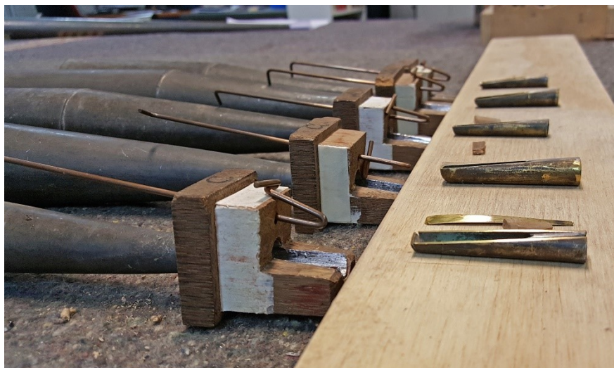
De unieke Cornet 2 voet bas van Andreas de Mare, ca. 1571, destijds Zink 8 voet discant. We zien de oude koppen en de taps toelopende kelen met deels nog oude tongen.
