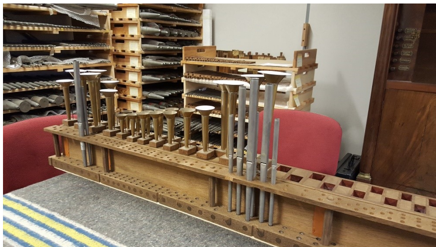
Het oppassen van Sexquialterpijpen op de oude pijpstk met oude en nieuwe pijpen in de werkplaats van Reil. Toen bleek dat de samenstelling lager was dan in 1969 uiteindelijk werd toegepast.
