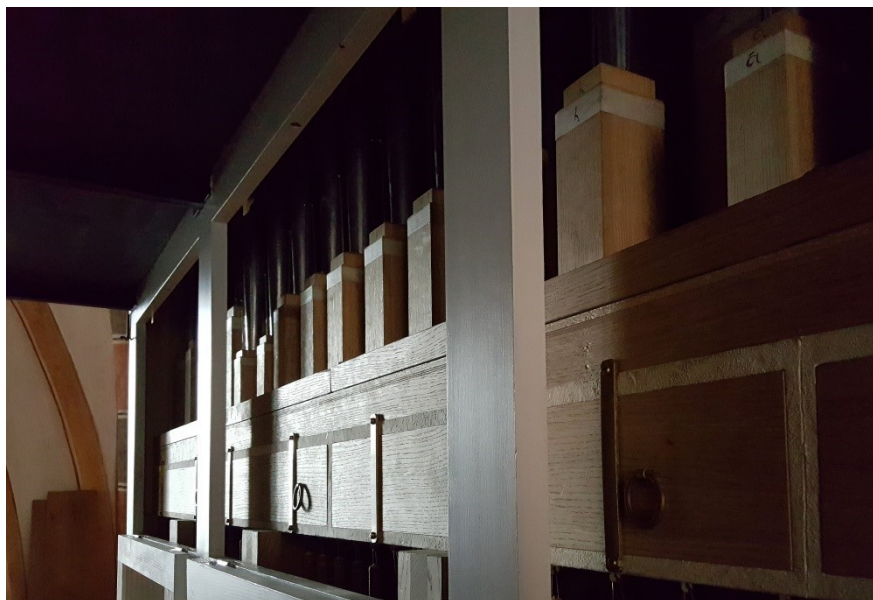
De nieuwe windlade van het vrije pedaal van Reil achter het Hinszorgel. Deze is in de stijl van Hinsz bijgemaakt.
